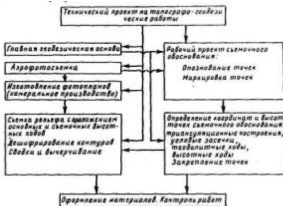
Рис. 2. Технологическая схема полевых работ при комбинированной съемке
